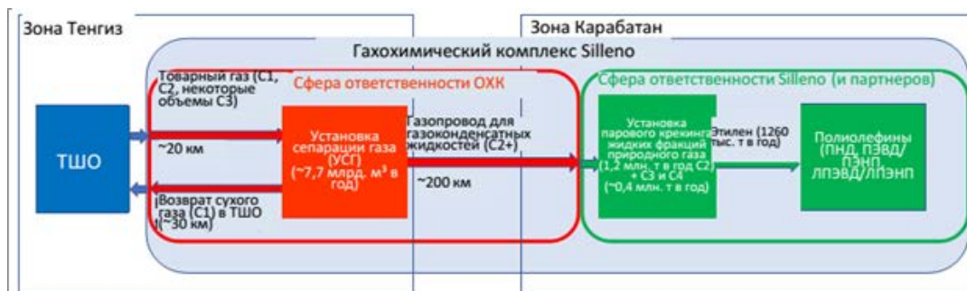
Схема поставки газа и конечной продукции в рамках проекта Газохимического комплекса Объединенной химической компании (ОХК)
